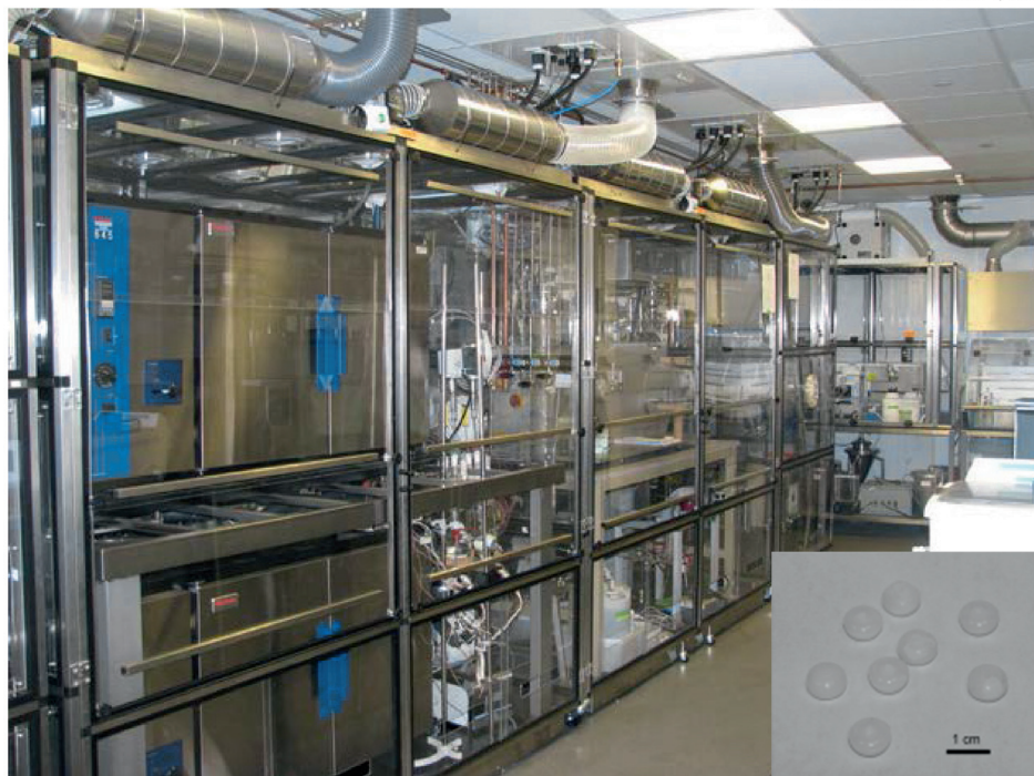
Schema 61. Integrierte kontinuierliche End-to-End-Produktionsanlage für die Synthese von Aliskiren. Der Einschub zeigt die formulierten Tabletten. Abdruck des Bildes mit Genehmigung aus Lit. [8a]. Copyright 2013, Wiley-VCH.
